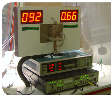
Måling av kritisk temperatur og motstand i en superleder ved Universitetet i Graz, Østerrike. Foto: SRD
